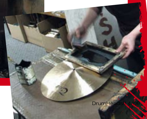
Im Siebdruckverfahren bringt ein Mitarbeiter das Logo aufs Becken.
